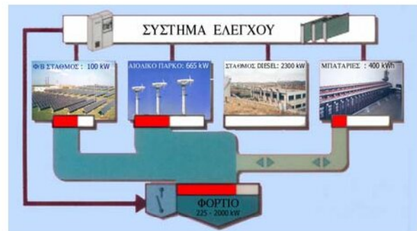
Διάγρ.2: Σχηματική παράσταση λειτουργίας του υβριδικού συστήματος της Κύθνου με κάλυψη των αναγκών του νησιού 100 % από ΑΠΕ . (Πετρελαϊκές μονάδες εκτός λειτουργίας)
